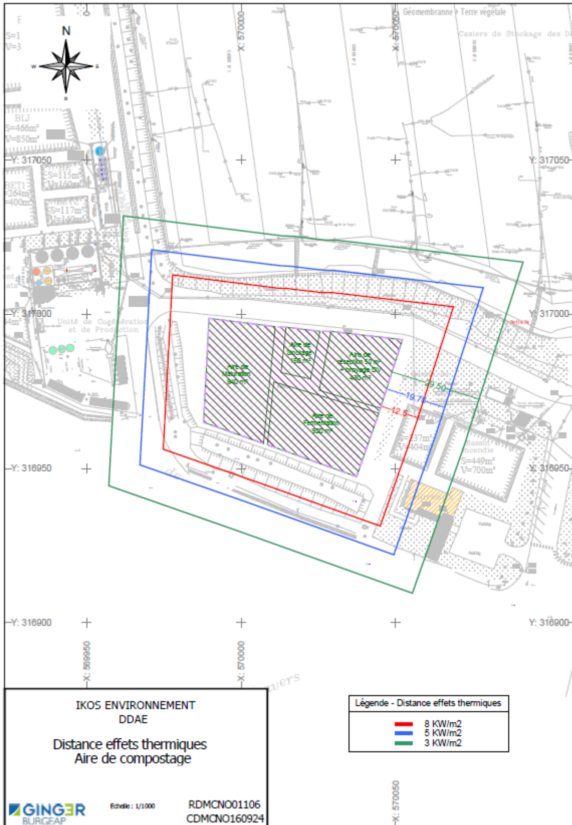
Figure 2 : Effets de thermique issus de l'incendie de la plateforme de compostage à hauteur d'homme
